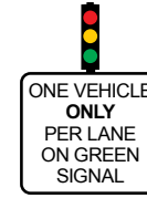
ป้ายตรงสัญญาณไฟควบคุมทางลาดบนมอเตอร์เวย์
