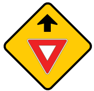
Biển báo 'Give way' ('Nhường đường') phía trước.
